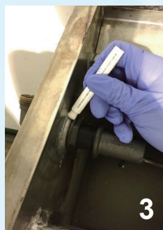
3 排出熱水罈內的水後，把驗鉛套件塗擦在熱水罈內入水位的錫焊接物料上。為避免任何液體滴入熱水罈，請用一塊濕布放在塗擦位置的底部。
